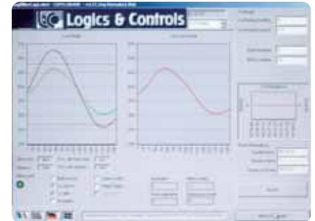
El exclusivo sistema de relevación de datos permite un doble análisis de la curva de presión de pasaje de la botella. El resultado es un sistema sumamente simplificado en la mecánica, de elevada capacidad y más higiénico.
