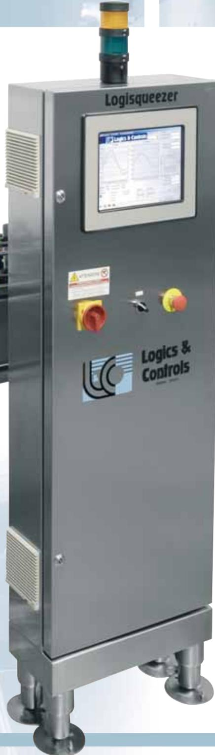
Con una acción progresiva, rápida y eficaz, se realizan presiones sumamente elevadas al interior del contenedor, pero sin causar irreversibles deformaciones estructurales en los contenedores correctamente cerrados.
