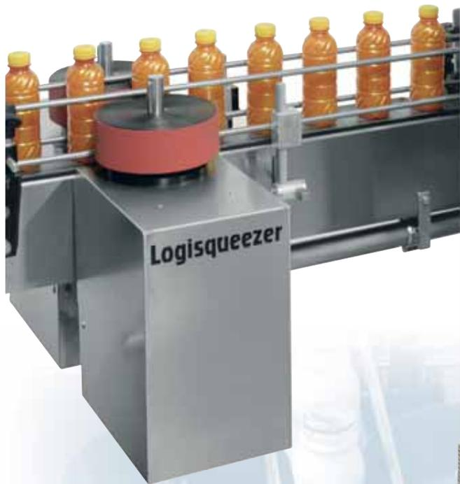
Comprimiendo lateralmente los envases durante el normal tránsito sobre el transportador, analiza la variación de presión al interior de la botella, individuando específicos escape de presión causado para fallos micrométricos.
